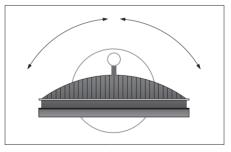
El televisor se puede inclinar hacia arriba y hacia abajo mientras permanece sobre un soporte motorizado de pie o de pared, aunque también se puede inclinar manualmente.
